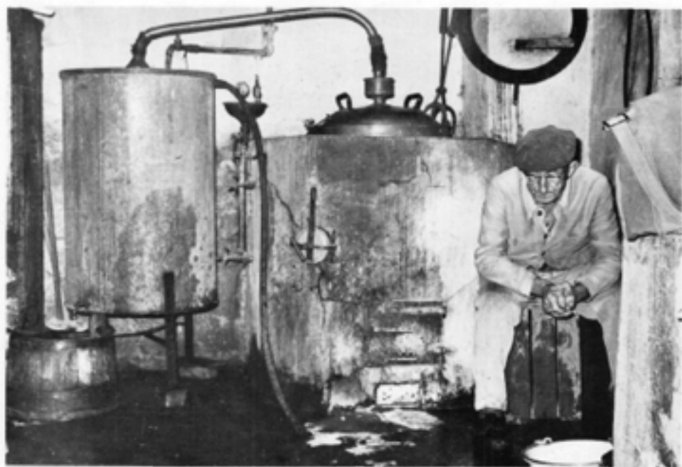
Tout est prêt pour la distillation. À droite on voit la cuve avec un foyer pour chauffer l'eau du bain-marie. À gauche il y a la cuve de refroidissement dans laquelle passe le serpentín de condensation.
